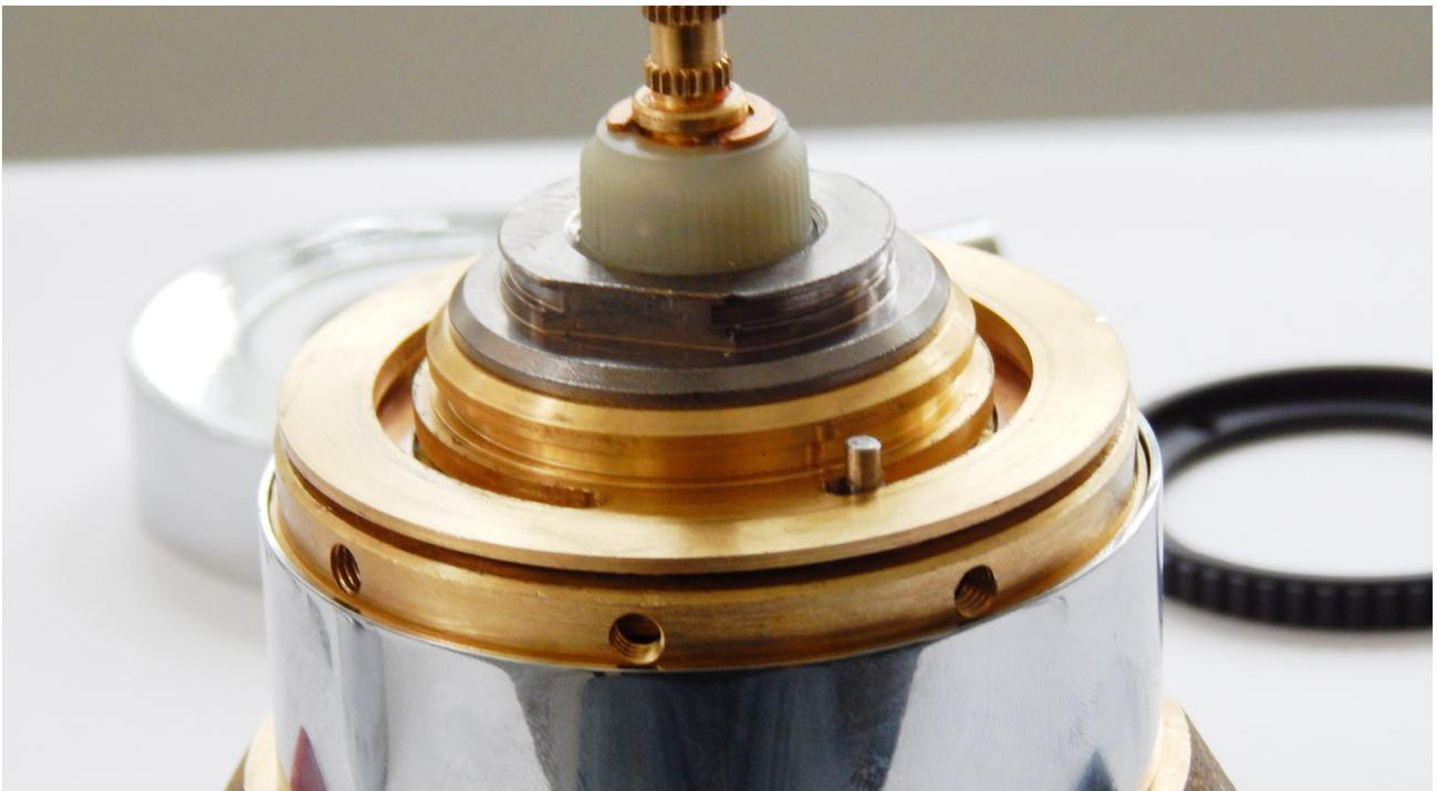
Bei der Montage darauf achten, dass der Messing Ring mit Thermoelement bündig im Körper sitzt. Da die Schrauben in die Vertiefung des Messing-Ringes hineinpassen müssen.
