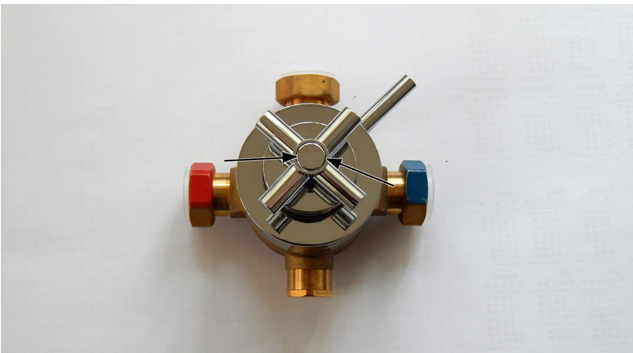
1.) Demontage der Kunststoffabdeckkappe: Vorsichtig einen kleinen, schmalen Schlitzschraubendreher in den Zwischenraum setzen und leicht mit einem Hammer hineintreiben, damit die Kappe angehoben wird.
