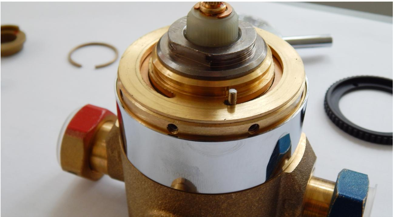
5.) Alle Schrauben aus dem Körper entfernen
